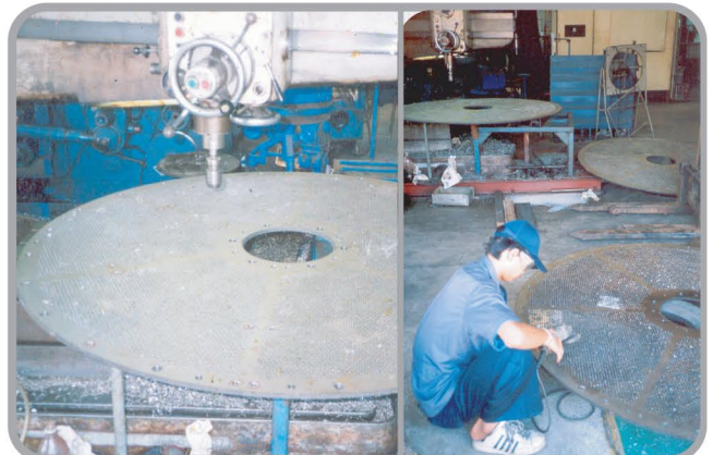
ตะแกรงกรองเยื่อสแตนเลส - ทำใหม่
