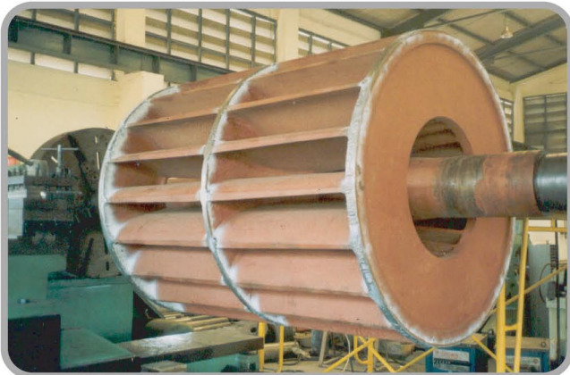
เชื่อมซ่อมตัวโรเตอร์ พร้อมพอกเพลารวมเคลือบไบพัต
