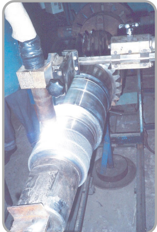
เชื่อมซ่อมเพลาดูด้วยระบบพลาสมา ลดการบิดงอ
