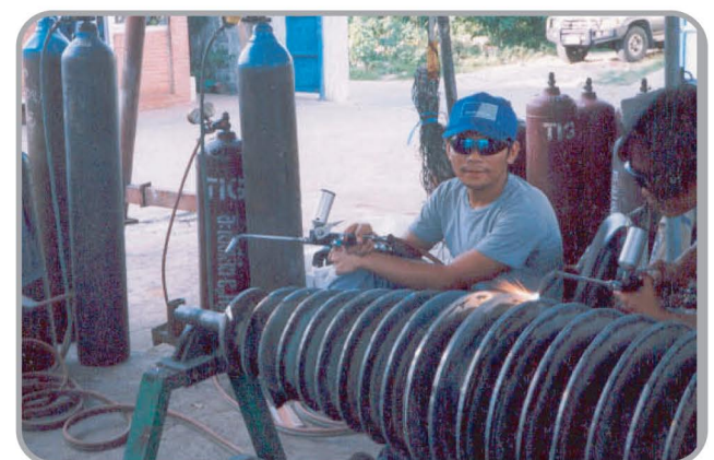
เคลือบส้นสกรูด้ายถังสแตนคาร์ไบค์
