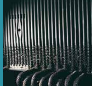
ผงพ่นพอกท่อไอน้ำในบริเวณที่ต้อง ได้รับความร้อนเพื่อเสริมสร้างความทนทานต่อการเปลี่ยนแปลงของ อุณหภูมิ สภาพแวดล้อมที่กัดกร่อน และระดับของอนุภาคที่ไม่คงที่
