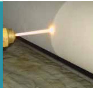
พ่น HVOF กับงานลูกกลิ้งในงาน อุตสาหกรรมการพิมพ์
